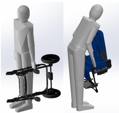
рис. 1.3 Правильный способ транспортировки коляски
