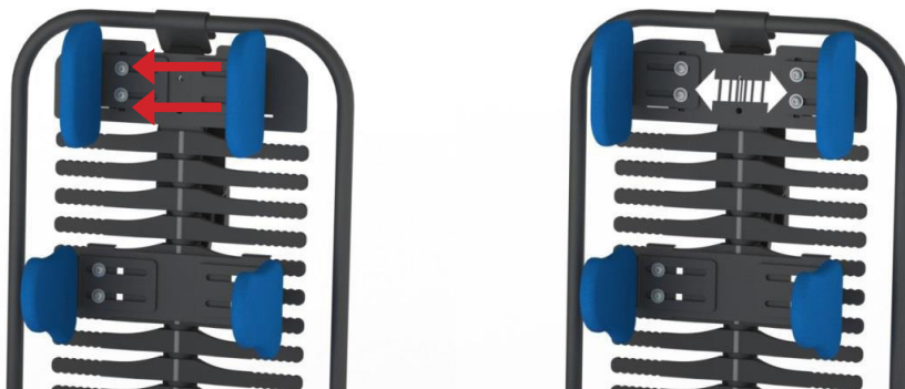
рис. 26 Регулирование боковых упоров для головы
